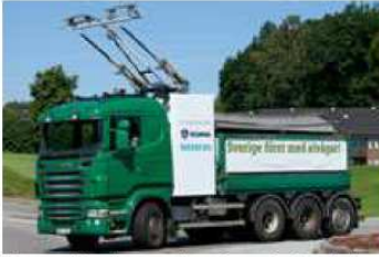
Maquette de camion Scania équipé d'un pantographe destiné à être relié à un câble d'alimentation électrique aérien. © Scania
